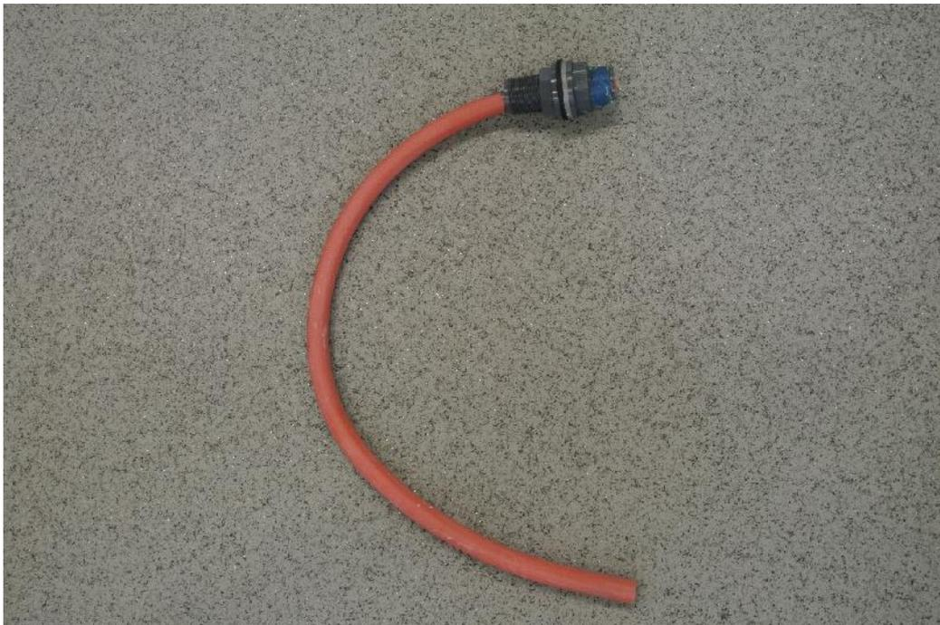
Abbildung 21: Adapter für Druckmessung
