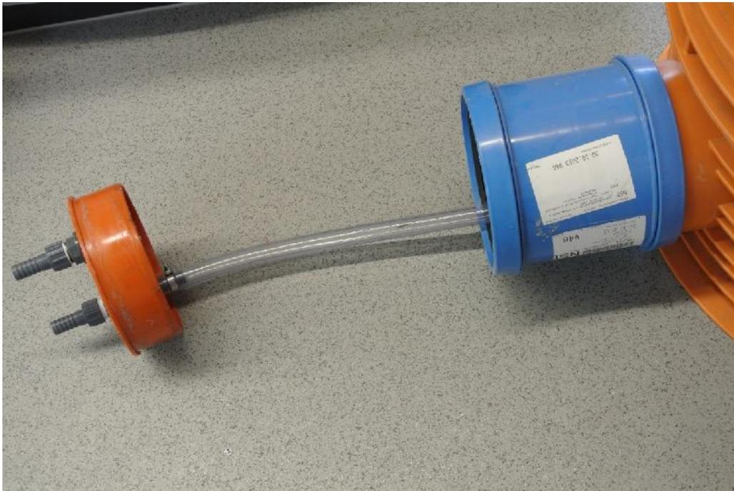
Abbildung 33: Muffenstopfen (14) mit Fermenterheizung verbinden
