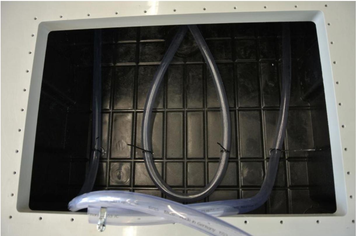
Abbildung 25: Perkolattank (1) mit Befestigungssockel (26)
