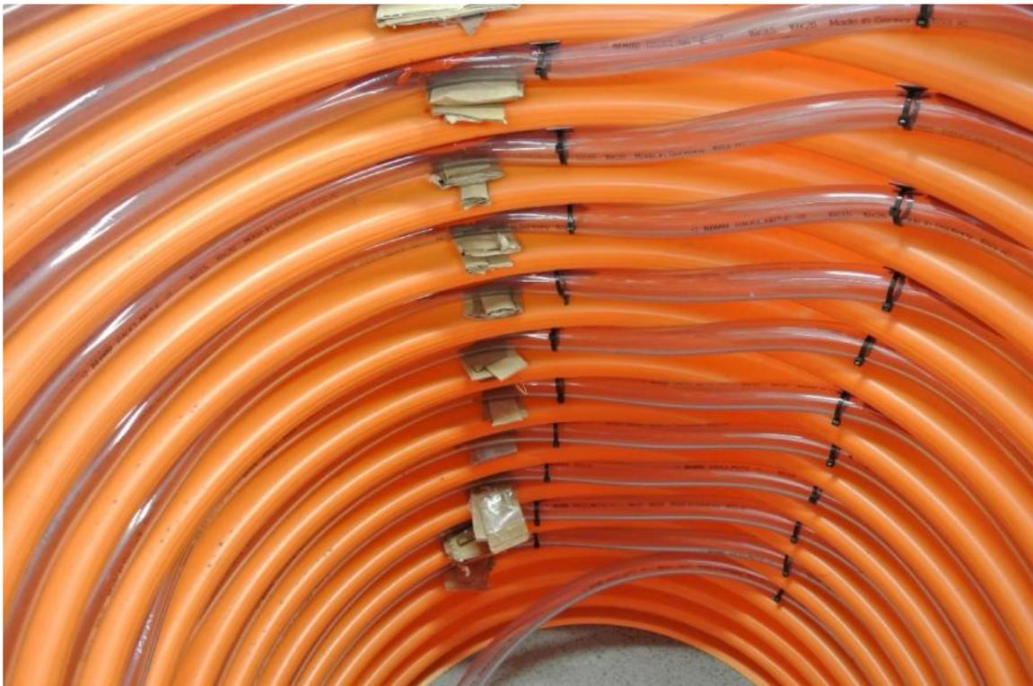
Abbildung 34: Verkleben des Fermenterrohr (5)
