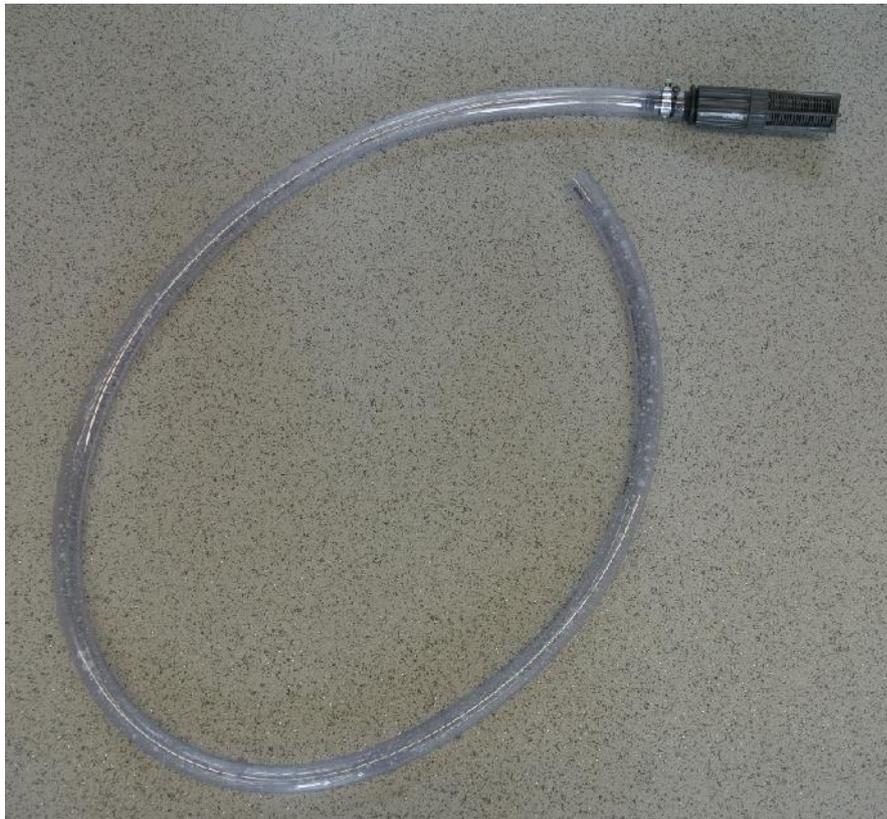
Abbildung 29: Saugfilter (19) mit Schlauch (20)
