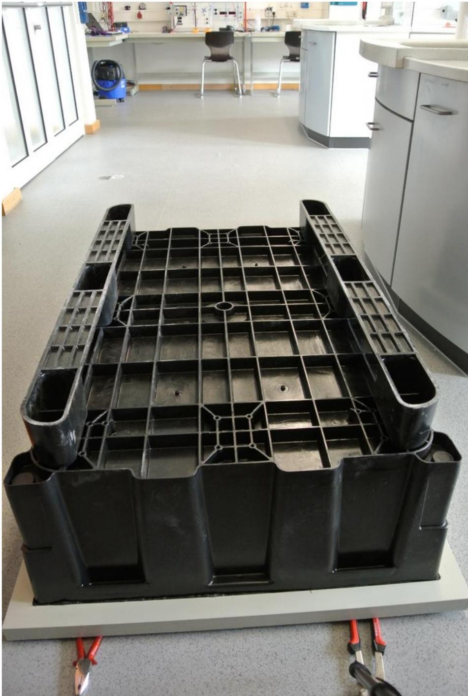
Abbildung 26: Verkleben des Perkolattanks (1) mit dem Perkolattankdeckel (2)
