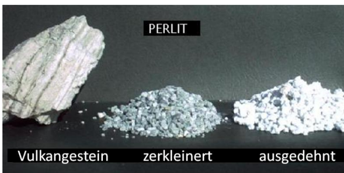
Abbildung 15: Der Weg vom Vulkangestein zum Perlit (modifiziert nach www.perlite.net )
