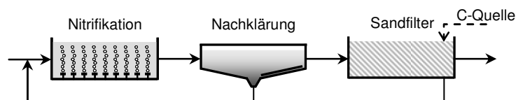
Abbildung 3: Verfahrensschema der nachgeschalteten Denitrifikation
